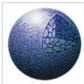
合成ゴムと合成樹脂を主材料とし、是に種々の用途に応じた副材料を**独自ブレンド**を行い高圧二段発泡法によって一つ一つが均一で強靱な膜を持った独立セルを形成し、**外膜は硬質な膜**で覆われており、外膜が損傷したり、貫通されても比重変化や沈むことは無い
